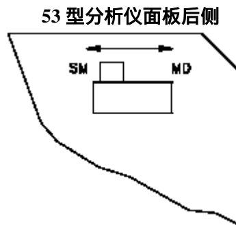
图 3-2 SINGLE MODE/MULTI-DROP (单模式/多点) 切换开关的位置 (仅针对配有 HART 的分析仪)
